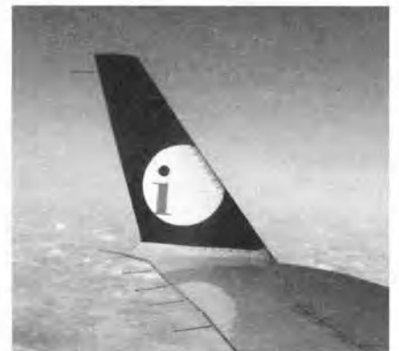
Рис. 6.3.7. Вертикальная законцовка мешает воздуху при обтекании конца крыла порождать в воздухе позади самолета мощный вихрь. Такие вихри приводят к напрасной потере энергии и представляют опасность для других самолетов.
