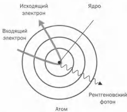
Рис. 16.3.1. Когда быстро движущийся электрон огибает массивное ядро, его скорость быстро возрастает. Это внезапное ускорение создает тормозной рентгеновский фотон, который забирает некоторую часть энергии электрона.
