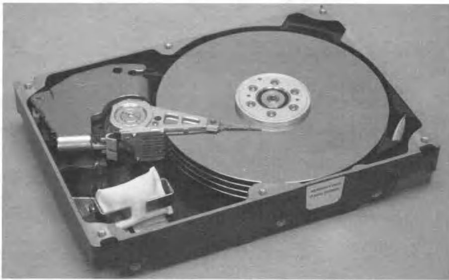
Рис. 11.5.8. В этом накопителе четыре диска и восемь записывающих магнитных поверхностей. У каждой поверхности отдельное магнитное покрытие и отдельные головки для чтения и записи. Головки могут за доли секунды перемещаться от центра диска к краю и наоборот.
