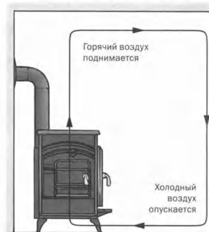
Рис. 7.1.6. Конвекция переносит тепло от горячей поверхности печи к потолку и стенам помещения. Теплый воздух поднимается вверх, поддерживаемый силой выталкивания, и заменяется более холодным воздухом, поднимающимся от пола. Нагретый воздух охлаждается и в конце концов снова опускается. Затем он возвращается к печи, чтобы повторить цикл.
