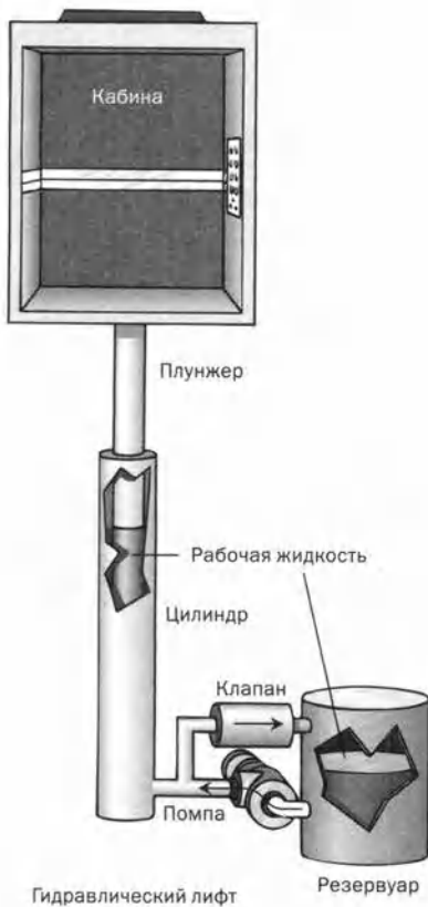
Рис. 4.4.2. Каabinу гидравлического лифта поднимает плунжер гидроцилиндра. Насос подает в полость цилиндра рабочую жидкость под высоким давлением, и плунжер поднимается. Когда клапан открывается и находящаяся под давлением рабочая жидкость перетекает обратно в резервуар, лифт спускается.
