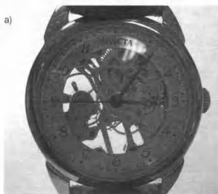
Рис. 9.1.7. (а) Балансировочное кольцо в современных прозрачных часах ритмично вращается взад-вперед под действием спиральной пружины; (б) для снижения трения и износа на анкере установлены крошечные драгоценные камни. (в) Старинные французские дорожные часы: баланс поддерживается крошечными рубиновыми опорами (в центре), которые помогают минимизировать трение и поддерживать очень точный ход.
