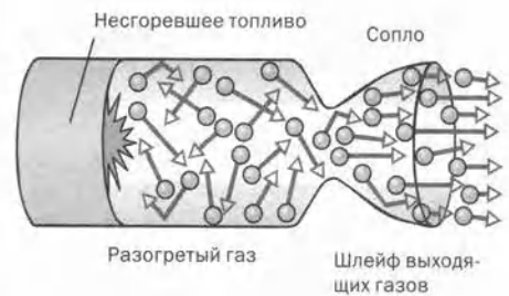
Рис. 4.2.2. Молекулярная картина процесса в ракетном двигателе, который работает на химическом топливе. Топливо сгорает в камере двигателя, и из сопла выбрасывается реактивная газовая струя. Сопло превращает хаотическое тепловое движение молекул газа в упорядоченный поток, направленный от ракетного двигателя.
