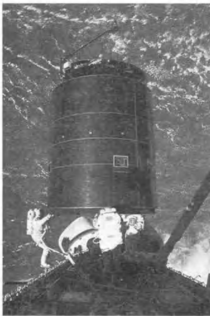
Рис. 2.1.8. 16 мая 1992 года трое астронавтов отремонтировали в открытом космосе телекоммуникационный спутник INTELSAT , но сначала им пришлось вручную остановить его вращение. Момент инерции спутника был велик, поэтому его угловая скорость затухала очень медленно, хотя астронавты приложили немалые моменты сил.
