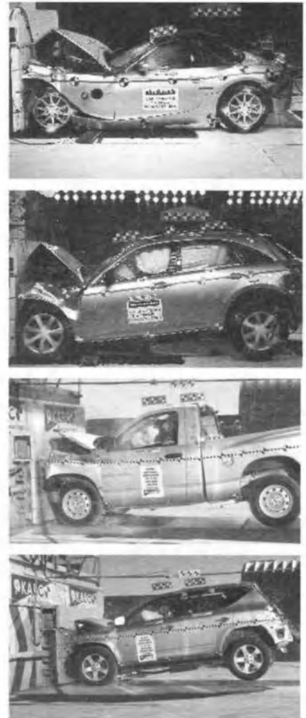
Рис. 2.3.3. Национальное управление по безопасности движения на автострадах США анализирует автомобильные аварии, чтобы выяснить, как ведут себя при столкновении те или иные транспортные средства. При лобовом ударе передние части кузовов этих легковых автомобилей и пикапов сминаются, поглощают энергию и замедляют передачу импульса. Одновременно разворачивается и надувается подушка безопасности, которая смягчает удар и оберегает человека. И пассажиры, и водитель теряют свои направленные вперед импульсы, но поскольку продолжительность процесса передачи импульса увеличивается, силы, участвующие в этой передаче, уменьшаются. Подушка безопасности поглощает импульс гораздо медленнее, чем руль и приборная доска, поэтому сила удара и риск серьезных травм значительно снижаются.
