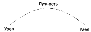
Рис. 9.2.3. Эта струна колеблется между двумя фиксированными точками в режиме нормальной моды. Струна движется целиком, поднимаясь и опускаясь как единый гармонический осциллятор. Она образует стоячую волну.
