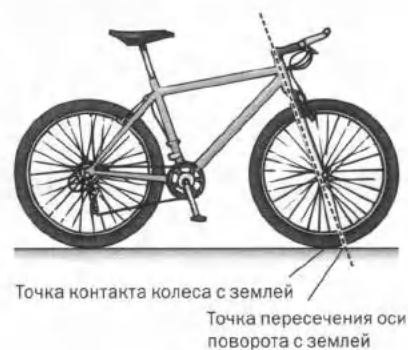
Рис. 4.1.4. Двухколесный велосипед устойчив во время движения отчасти потому, что его переднее колесо соприкасается с землей позади оси поворота. Благодаря этому колесо естественным образом поворачивает в сторону крена едущего велосипеда и возвращает его в вертикальное положение.
