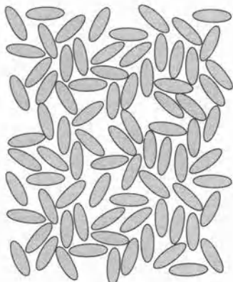
Рис. 7.5.4. В обычной жидкости атомы или молекулы расположены беспорядочно. Они касаются друг друга, но не образуют упорядоченную решетку.
