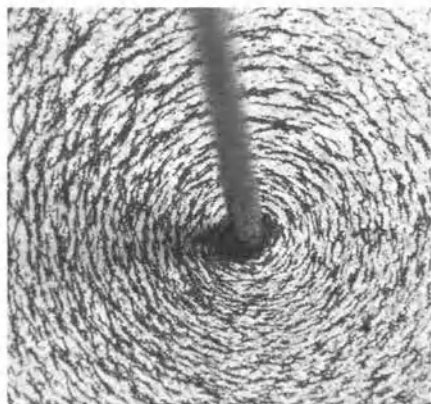
Рис. 11.1.9. Железный порошок демонстрирует, что линии магнитной индукции около проводника, по которому течет ток, образуют вокруг проводника концентрические окружности.
