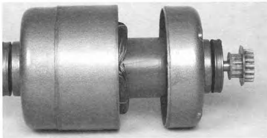
Рис. 11.3.8. В этом разобранным асинхронном двигателе ротор типа “беличье колесо” окружен стационарными электромагнитными обмотками. Магнитное поле обмоток вращается вокруг ротора, и ротор вращается вместе с ним. Для повышения производительности двигателя сердечник ротора набирается из отдельных стальных пластин.
