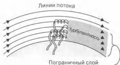
Рис. 6.2.9. Пограничный слой становится турбулентным еще до того, как число Рейнольдса вырастет до 100 000, благодаря помехам — ворсу и ямкам.
