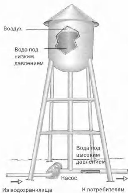
Рис. 5.2.8. Водонапорная башня, используя вес воды, создает высокое давление воды на уровне земли. Чем выше башня, тем больше давление в ее нижней части. Водонапорная башня в состоянии пассивно поддерживать давление воды и не требует постоянной подкачки. Даже в часы максимального водопотребления в сети сохраняется устойчивое давление. Когда уровень воды в башне падает ниже определенной отметки, насос вновь наполняет башню.
