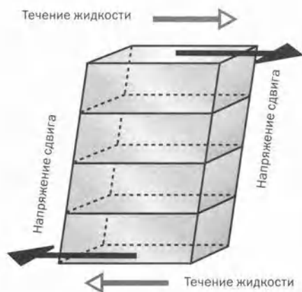
Рис. 17.2.2. Вязкость говорит о способности слоев жидкости смещаться относительно друг друга. Чем больше вязкость, тем более значительное напряжение сдвига требуется для того, чтобы нижние слои жидкости достаточно быстро текли влево, а верхние — вправо.
