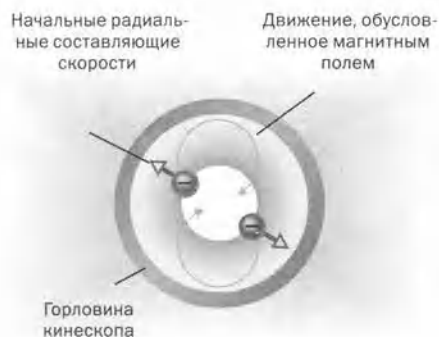
Рис. 13.3.4. По мере того как расходящиеся электроны летят по горловине кинескопа к экрану, фокусирующее магнитное поле придает им ускорение вправо. Электроны двигаются по спирали и вновь сходятся вместе в точке столкновения с экраном.
