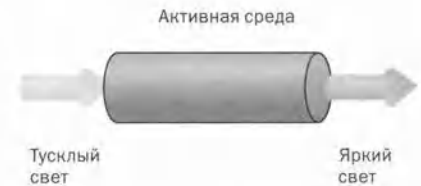
Рис. 14.3.2. Для увеличения количества частиц света, выходящих из активной среды, лазерный усилитель использует возбужденные атомы или атомоподобные системы. Входящий свет дублируется при помощи вынужденного излучения.
