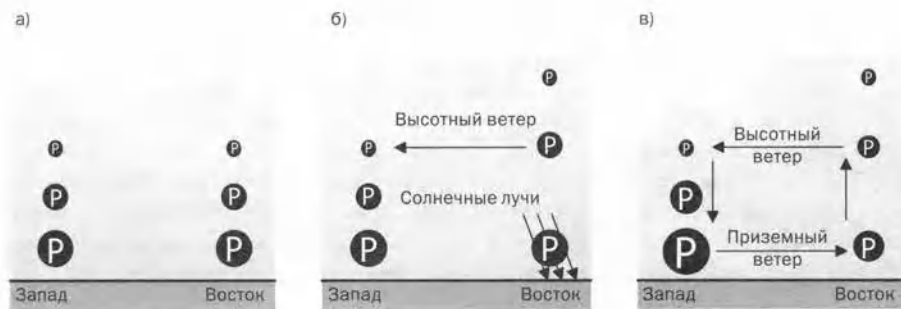
Рис. 8.3.2. (а) Когда температура земли на разных участках одинакова, ветра нет. (б) Когда восточный участок нагревается, воздух над ним расширяется вверх. Высотный ветер начинает дуть в сторону более холодного участка. (в) Увеличившийся вес воздуха в западной части повышает давление на уровне земли и вызывает приземный ветер, который дует в сторону более теплой восточной части. Образуется конвективная ячейка.
