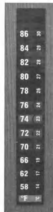
Рис. 7.5.9. В этом термометре на полимерной пластине размещены 12 различных жидких кристаллов, каждый из которых отражает свет в определенном, очень узком интервале температур. В данный момент жидкий кристалл, нанесенный позади отметки 74 °F (23 °C), интенсивно отражает свет, показывая, что температура в комнате близка к этому значению.
