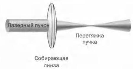
Рис. 15.2.4. Когда собирающая линза фокусирует лазерный пучок, свет не сходится в какой-то одной точке. Вместо этого он образует перетяжку с диаметром, примерно равным длине световой волны.
