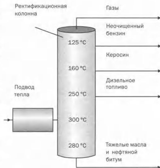
Рис. 18.1.10. От входа сырой нефти в ректификационную колонну до верха колонны температура понижается. Соотношение различных молекул в жидких смесях, которые собирают с тарелок на разных уровнях и при разных температурах, соответствует разным нефтепродуктам.
