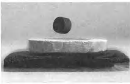
Рис. 11.2.1. Магнитный цилиндр парит над поверхностью сверхпроводника при температуре 78 К. Токи, свободно текущие по сверхпроводнику, наделяют его магнитными свойствами и заставляют его отталкивать магнитный цилиндр. Полное вытеснение линий магнитного поля из объема сверхпроводника называется эффектом Мейснера.
