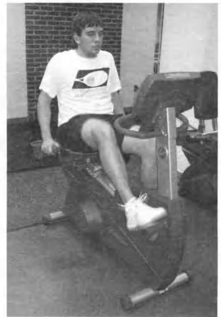
Рис. 1.3.7. Когда вы давите на педаль, вы совершаете над ней работу и таким образом передаете энергию велотренажеру. Тренажер по большей части превращает вашу мускульную энергию в тепловую, отчего нагревается воздух в зале, а также генерирует электричество для собственного электронного оборудования.
