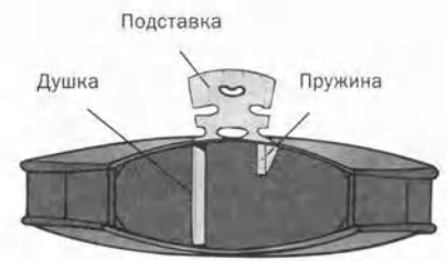
Рис. 9.2.11. Подставку поддерживают с одной стороны душка, а с другой — пружина. Когда струны вибрируют, подставка получает крутящий момент, который вызывает колебания верхней деки, что и создает звук.
