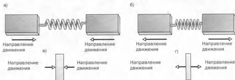
Рис. 9.1.8. Кристалл кварца действует как пружина с грузами на каждом конце. Так же как две массы попеременно то сближаются (а), то отдаляются (б), так и две половинки вибрирующего кристалла то сближаются (в), то отдвигаются друг от друга (г).
