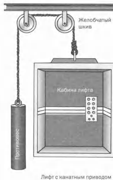
Рис. 4.4.7. Кабина и противовес лифта с тросовым приводом крепятся к противоположным концам троса. Электромотор приводит в действие желобчатый шкив, в результате чего кабина поднимается или опускается. Противовес движется в обратную сторону и тем самым помогает электромотору поднимать лифт, а во время спуска кабины запасает энергию.
