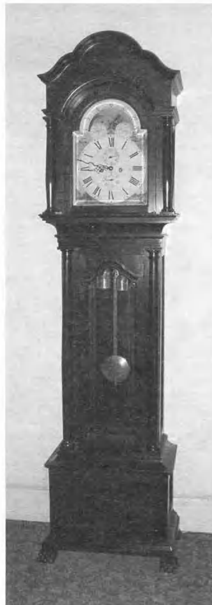
Рис. 9.1.3. Ход этих старинных часов управляется движением маятника. Длина маятника 0,992 м от точки подвеса до центра тяжести. Каждый цикл совершается за 2 секунды, и стрелка передвигается тоже на 2 секунды.
