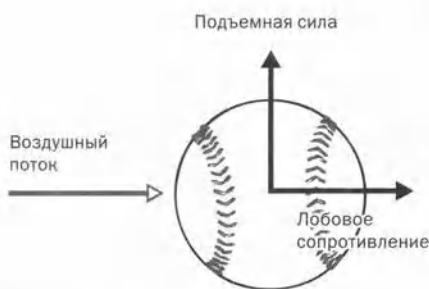
Рис. 6.2.1. На тело в воздухе действуют аэродинамические силы двух типов — сила лобового сопротивления и подъемная сила. Лобовое сопротивление действует в направлении, параллельном набегающему потоку, и замедляет движение тела в воздухе. Подъемная сила направлена перпендикулярно воздушному потоку и толкает тело в ту или другую сторону. Подъемная сила не всегда направлена вверх.
