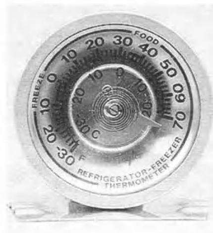
Рис. 7.5.6. В термометре холодильника для измерения температуры используется свернутая в спираль биметаллическая полоса. При охлаждении полоса раскручивается.
