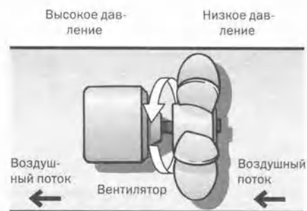
Рис. 6.4.3. Лопасти вращающегося вентилятора пылесоса гонят воздух из области низкого давления в область высокого давления, при этом совершая работу над воздухом и повышая его полную энергию.
