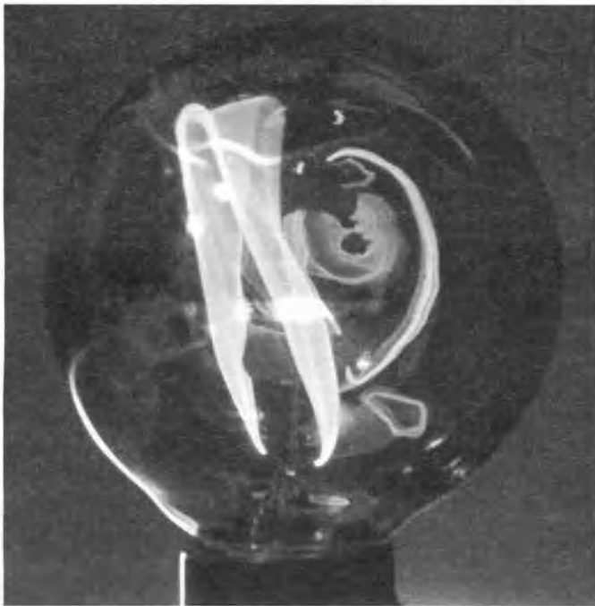
Рис. 11.3.9. В мерцающей лампе накаливания тонкая углеродная нить обвивает стержень из постоянного магнита (на фото — в нижней части, в центре). Когда по нити течет переменный ток, на него действует сила Лоренца. Поскольку ток ограничен пределами нити, сила Лоренца действует на всю нить, и нить приобретает ускорение. В результате нить плавно движется в хаотическом танце, напоминая пламя свечи.
