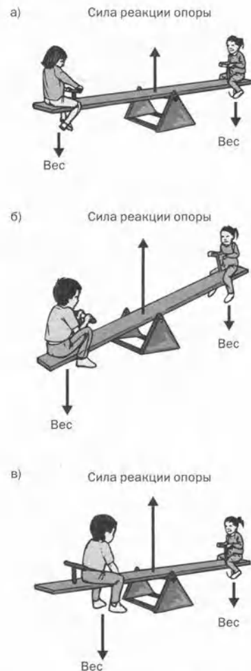
Рис. 2.1.1. (а) Если на качелях сидят дети с одинаковым весом, качели уравновешены. (б) Если вес у детей разный, более тяжелый ребенок опускается. (в) Если более тяжелый ребенок придвинется ближе к оси вращения, качели снова уравновесятся.
