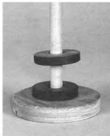
Рис. 11.4.1. Два магнитных диска отталкиваются, потому что обращены друг к другу северными полюсами. Однако чтобы верхний диск не упал с магнитной подушки, которая его поддерживает, необходима ось.
