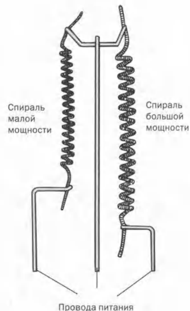
Рис. 7.3.9. В двухнитевой лампе используются две независимые спирали. Левая спираль короче и тоньше правой, поэтому дает примерно в два раза меньше света. Три разных световых режима соответствуют включенной левой, включенной правой и обеим включенным спиралям.
