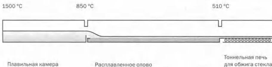
Рис. 17.2.5. Чтобы изготовить термополированное стекло, жидкую стекломассу разливают по поверхности расплавленного олова. Выходящая из плавильной камеры лента из жидкого стекла охлаждается и затвердевает. На завершающей стадии стекло подвергают обжигу в тоннельной печи, после чего нарезают на листы.
