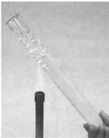
Рис. 7.4.2. Конвекция происходит, только если более горячий объект расположен рядом или ниже более холодного, чтобы теплый поток мог подниматься вверх. Если нагревать верхнюю часть наполненной водой пробирки, горячая вода будет оставаться сверху, а холодная — внизу. Так как вода — плохой проводник тепла, вода в верхней части пробирки может даже закипеть, в то время как вода в нижней останется настолько холодной, что пробирку можно держать в руке.
