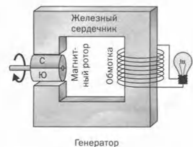
Рис. 11.3.1. Этот генератор очень напоминает трансформатор с рис. 11.2.7 , за исключением того, что энергия передается от вращающегося магнитного ротора, а не от тока в первичной обмотке.
