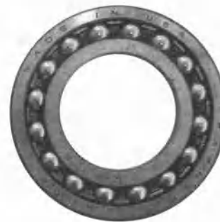
Рис. 2.2.7. Вместо цилиндрических роликов, которые используются в роликовых подшипниках, в шарикоподшипнике применяют шарики. Шарики выполняют ту же функцию, что и ролики, но они легче и с ними проще работать, поэтому шарикоподшипники очень удобны, если нет чрезмерных нагрузок — например, в велосипедах и различных бытовых приборах, где есть вращающиеся детали. Однако шарики имеют ряд недостатков. В частности, из-за того что внутри подшипника ось опирается на очень небольшую долю поверхности каждого шарика, при излишней нагрузке они могут деформироваться, и подшипник начнет стирать сам себя. Шарики для подшипников должны быть изготовлены с высочайшей точностью — они должны быть абсолютно одинаковыми и идеально круглыми, — тогда вероятность деформации уменьшается.
