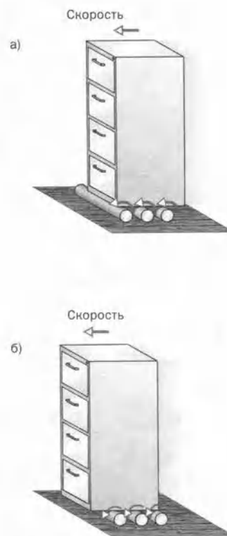
Рис. 2.2.3. (а) Шкаф, под который подложены катки (валики), испытывает действие только силы трения покоя. (б) Поскольку верхняя поверхность каждого катка перемещается вперед вместе со шкафом, в то время как нижняя поверхность остается позади на тротуаре, центр масс катка движется вдвое медленнее шкафа. В результате валики один за другим выкатываются сзади из-под шкафа.
