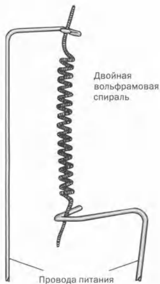
Рис. 7.3.5. Вольфрамовая нить современных ламп накаливания представляет собой двойную спираль, то есть пружину, скрученную, в свою очередь, из пружины меньшего диаметра, свитой из чрезвычайно тонкой вольфрамовой проволоки. Благодаря этому проволока большой длины занимает очень мало места.
