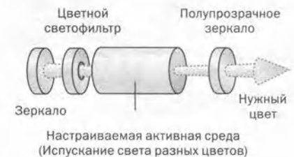
Рис. 14.3.7. Некоторые активные среды могут усиливать свет разных длин волн. После установки между зеркалами цветного светофильтра лазерный генератор испускает свет только определенной длины волны.
