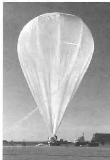
Рис. 5.1.10. Исследовательский научный шар, наполненный гелием, готов отправиться в путешествие в верхние слои атмосферы. К тому моменту, когда шар достигнет рабочей высоты 40 км, его объем увеличится примерно в 100 раз.
