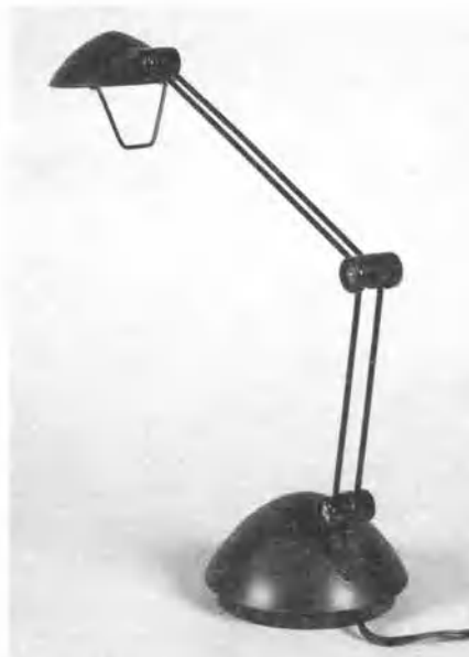
Рис. 11.2.6. Галогенная лампочка этой настольной лампы работает от низкого напряжения 12 вольт, поставляемого через трансформатор. Переменный ток течет к лампе и от нее по двум опорным элементам.
