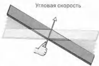
Рис. 2.1.4. Доска качелей поворачивается вокруг показанной на рисунке оси вращения. Направление угловой скорости определяется по правилу правой руки.
