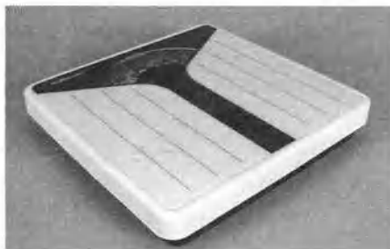
Рис. 3.1.4. Когда вы встаете на эти весы, платформа немного смещается вниз и сжимает жесткую пружину. Степень сжатия пропорциональна вашему весу, который можно узнать по цифрам на шкале. Рычаги в механизме весов компенсируют погрешность, возникающую из-за того, что при каждом взвешивании вы можете стоять на разных частях платформы.
