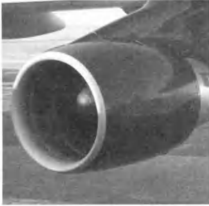
Рис. 6.3.14. Турбовентиляторный двигатель под крылом большого реактивного лайнера. Обтекатель канала вентилятора (темная широкая часть двигателя) гораздо короче, чем выступающее из него блестящее сопло турбореактивного двигателя, вращающего вентилятор.
