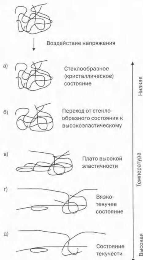
Рис. 17.3.3. По мере нагревания полимер последовательно принимает пять состояний, как показано на рисунке сверху вниз. (а) На холоде атомы под воздействием напряжения не смещаются, поэтому полимер находится в стеклообразном состоянии. (б) Атомы менее охлажденного полимера способны медленно перемещаться, но цепные молекулы неподвижны, что соответствует переходному состоянию между стеклообразным и эластичным. (в) При средних температурах атомы и молекулы подвижны, но переплетения цепей мешают их относительному смещению — это режим высокой эластичности. (г) При дальнейшем нагревании цепочки расплетаются, и наступает вязкотекучее состояние. (д) Молекулы горячего полимера легко распрavляются, и полимер течет, как жидкость.
