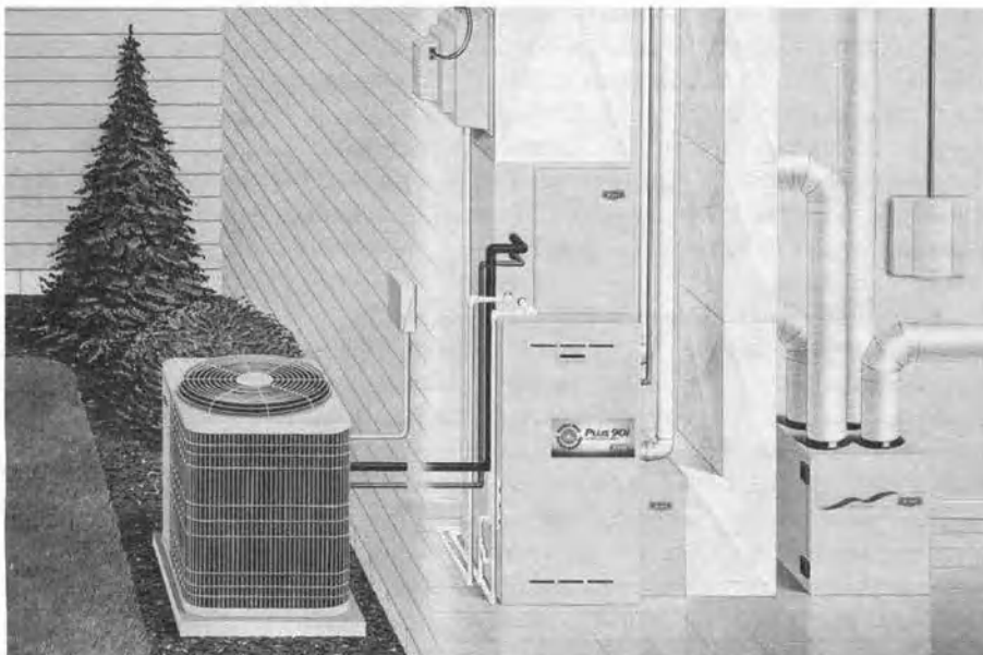
Рис. 8.1.3. Испаритель этой установки центрального кондиционирования извлекает тепло из внутреннего воздуха помещения. Это тепло переносится наружу, где компрессор и конденсатор передают его наружному воздуху.
