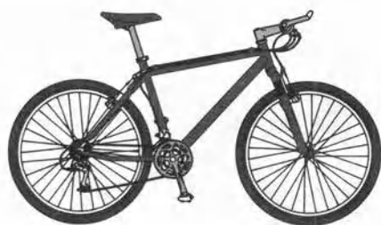
Рис. 4.1.9. Современный двухколесный велосипед. Заднее колесо приводится в движение цепью, что дает велосипедисту возможность варьировать выигрыш в силе при передаче крутящего момента от педалей на заднее колесо. Трещотка втулки заднего колеса дает ему возможность свободно вращаться в одном направлении. Благодаря этому механизму велосипед может ехать по инерции при неподвижных педалях.
