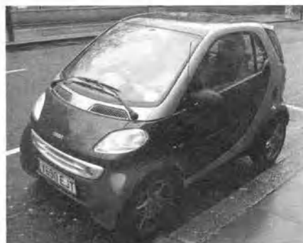
Рис. 8.2.6. Этот автомобиль предназначен для городского режима движения, и ему требуется совсем немного места для парковки. Зато у него относительно высокий коэффициент лобового сопротивления.
