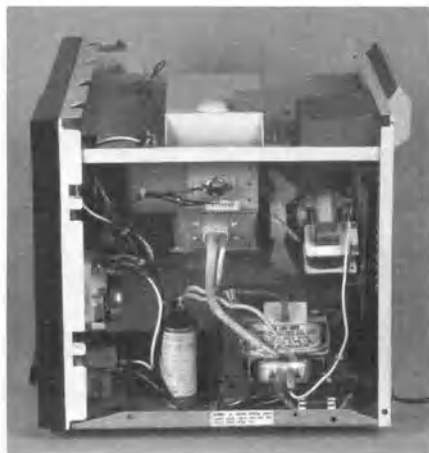
Рис. 13.2.3. В центре рисунка, слева от охлаждающего вентилятора, расположен магнетрон — источник микроволн для этой печи. Микроволны попадают в рабочую камеру по металлическому волноводу в верхней части печи. Источником питания для магнетрона служит высоковольтный трансформатор (внизу справа).
