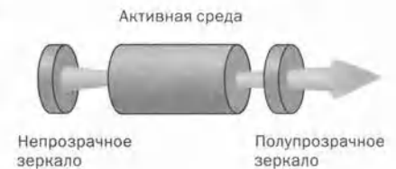
Рис. 14.3.3. Лазерный генератор представляет собой лазерный усилитель, помещенный между двумя зеркалами. Колебания возникают, когда активная среда самопроизвольно испускает один фотон в нужном направлении. Этот фотон, отражаясь в зеркалах, многократно дублируется. Делая одно из зеркал полупрозрачным, часть света удаляют из лазера.
