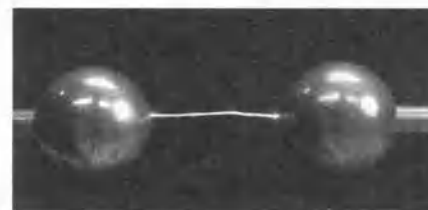
Рис. 10.2.7. Эти два металлических шарика находятся на расстоянии 1 см друг от друга. Когда разность потенциалов между ними равна примерно 30 000 В, происходит пробой воздуха с образованием искры.
