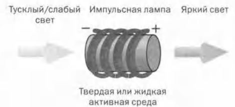
Рис. 14.3.6. В лазере с оптической накачкой интенсивный свет от импульсной лампы, дуговой лампы или даже другого лазера передает энергию активной среде. Атомы или атомоподобные системы внутри активной среды хранят эту энергию и используют ее для усиления света.
