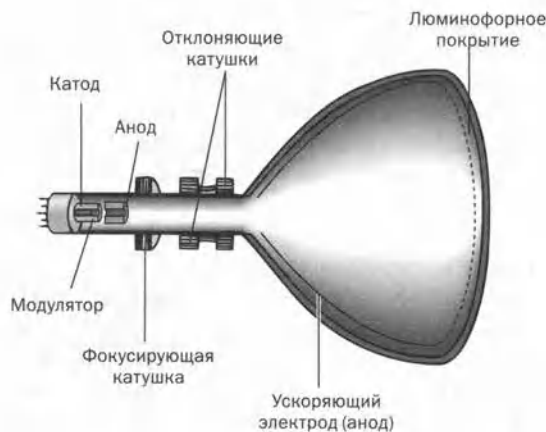
Рис. 13.3.1. Основные компоненты черно-белого кинескопа. Электроны движутся слева направо и освещают экран.
