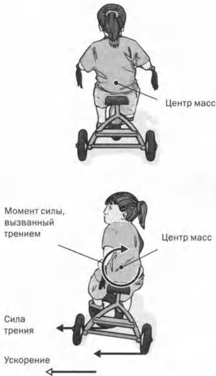
Рис. 4.1.3. (а) Пока велосипед едет прямо, он устойчив, потому что при любом наклоне его центр тяжести поднимается. (б) Но если резко свернуть влево, трение создаст большую силу, действующую на колесо и направленную влево, и велосипед приобретет направленное влево ускорение. Эта сила трения порождает момент силы относительно общего для девочки и велосипеда центра масс, который заставляет велосипед упасть.
