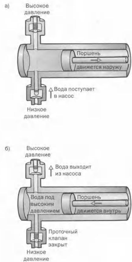
Рис. 5.2.3. Поршневой насос перекачивает воду из области низкого давления в область высокого давления. (а) Когда поршень движется наружу, вода поступает в цилиндр из области низкого давления. (б) Когда поршень движется внутрь, проточный клапан закрывается и вода поступает из цилиндра в область высокого давления.
