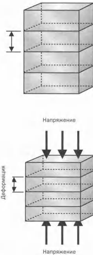
Рис. 17.1.3. Под воздействием направленного внутрь напряжения сталь сжимается. Напряжение равно силе, направленной внутрь и приложенной к единице площади поверхности. Напряжение вызывает деформацию стали. Деформация — это относительное изменение длины образца, то есть изменение его длины, деленное на первоначальную длину.
