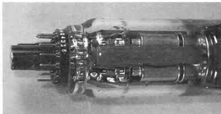
Рис. 13.3.3. Два из трех источников электронов в цветном кинескопе. У каждого источника имеется собственный катод, модулятор и анод, и каждый источник отвечает за освещение одного из цветных люминофоров.
