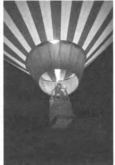
Рис. 5.1.5. Отверстие в нижней части воздушного шара остается открытым, чтобы горячий воздух мог входить внутрь, а холодный — выходить наружу. Горячий воздух вытесняет больший объем по сравнению с холодным, поэтому воздушный шар становится легче.
