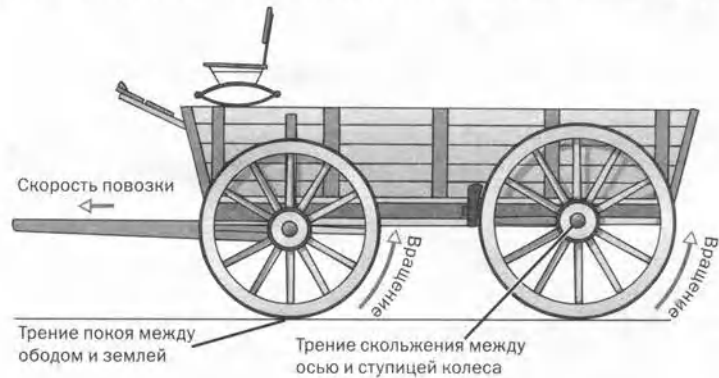
Рис. 2.2.4. Повозка едет влево, и колеса крутятся против часовой стрелки. На внешний обод колеса действует только сила трения покоя, но ступица скользит вокруг оси и превращает кинетическую энергию телеги в тепловую. Чтобы снизить потери энергии, диаметр ступиц делают по возможности небольшим, а оси смазывают машинным маслом.
