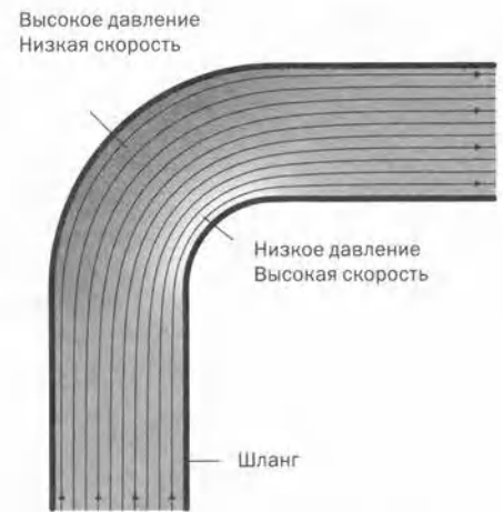
Рис. 6.1.2. Скорость и давление воды в изогнутом шланге изменяются. Черные линии указывают путь воды на изгибе шланга. Интервалы между линиями соответствуют снижению скорости (на участках с широкими интервалами поток замедляется), а оттенки фона показывают разницу в давлении (на темных участках давление выше, на светлых — ниже).
