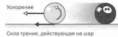
Рис. 3.2.10. Вращение битка до соударения влияет на его дальнейшее движение. (а) В случае наката (верхнего вращения) трение о стол придает битку после соударения направленное вперед ускорение, поэтому биток догоняет прицельный шар. (б) Если биток не подкручен, после столкновения с прицельным шаром он остановится. (в) В случае удара с оттяжкой (нижнего вращения) после попадания в прицельный шар ускорение битка из-за трения направлено назад, поэтому биток удаляется от прицельного шара.
