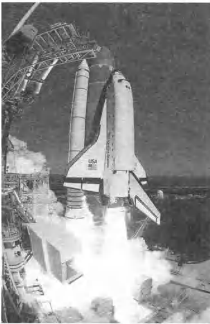
Рис. 4.2.3. Колоколовидные сопла Лавалья, которые использовались в космических челноках, сконструированы таким образом, чтобы газы реактивной струи выбрасывались вниз в виде длинных струй пламени, толкающих ракету вверх.
