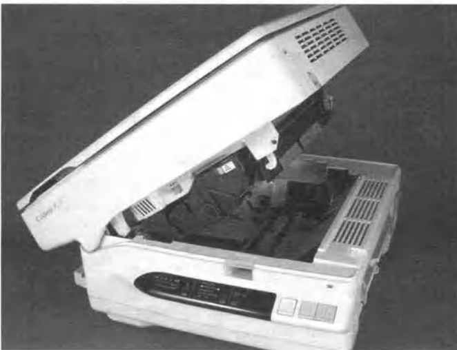
Рис. 10.2.4. В этом копировальном аппарате фотобарабан, запас тонера и коротрон переноса размещены внутри сменного картриджа. После прохождения бумаги через картридж тонер закрепляется на ее поверхности, и копия выходит из аппарата.
