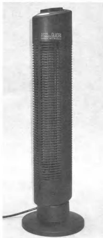
Рис. 10.2.12. В этом бытовом электронном очистителе воздуха внутри пластмассового корпуса размещены два коронирующих электрода и три осадительные пластины. Поток зарядов от электродов к пластинам заставляет воздух проходить через фильтр, поэтому в таком очистителе не нужен отдельный вентилятор.
