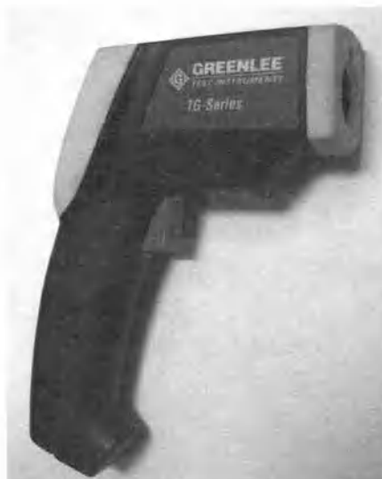
Рис. 7.5.12. Этот оптический термометр фиксирует тепловое излучение поверхности и использует его интенсивность для определения температуры этой поверхности. Предполагается, что поверхность имеет высокую излучательную способность. Однако прибор можно приспособить к использованию и при других значениях коэффициента излучения. Термометр проецирует лазерное кольцо, чтобы обозначить границы поверхности измерения.
