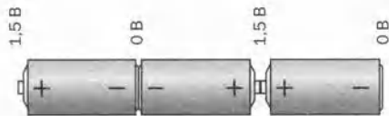
Рис. 10.3.8. Когда в цепи одна из трех батарей установлена задом наперед, потенциал развернутой батареи вычитается из суммы потенциалов двух других. Суммарная разность потенциалов между положительным и отрицательным выводами составляет только 1,5 В. Развернутая батарея подзаряжается.
