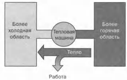
Рис. 8.2.1. Тепловая машина превращает тепло (тепловую энергию горячей области) в работу (упорядоченную энергию), когда тепло переходит из горячей области в холодную. Чем больше разность температур между двумя областями, тем большую часть тепла можно превратить в работу.
