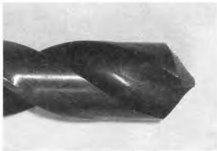
Рис. 2.3.7. Когда сверло, прижатое к металлической заготовке, вращается по часовой стрелке, две его заточенных режущих кромки отрезают от поверхности металла стружку. Косые кромки дают выигрыш в силе, поэтому достаточно сообщить сверлу небольшой момент силы, чтобы острые кромки, двигаясь по кругу на поверхности металла, начали срезать стружку.
