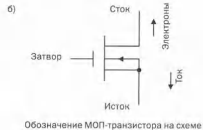
Рис. 12.2.4. (а) В n-канальном МОП-транзисторе канал, как правило, представляет собой обедненный слой, который не может проводить ток между истоком и стоком. Но когда положительный заряд на затворе притягивает электроны в канал, последний становится полупроводником n-типа и делает возможным протекание тока. (б) Обозначение n-канального МОП-транзистора на электрической схеме.
