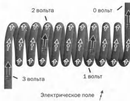
Рис. 10.3.10. При прохождении через эту нить заряды испытывают падение напряжения, равное 3 В. Возникающее в результате электрическое поле толкает их вперед. Заряды сохраняют постоянную скорость, несмотря на частые столкновения с атомами вольфрама.
