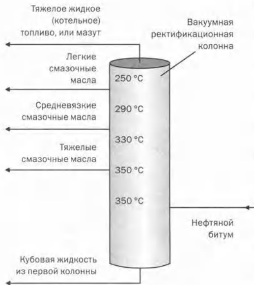
Рис. 18.1.12. При низком давлении в вакуумной ректификационной колонне удается превратить в газ даже малолетучие смазочные масла.
