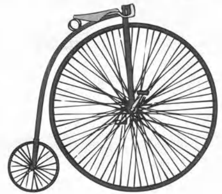
Рис. 4.1.6. Для того чтобы велосипедист мог ехать с разумной скоростью и при этом не слишком быстро крутить педали, велосипеды “пенни-фартинг” имели большое переднее колесо, непосредственно на оси которого были закреплены педали. Соотношение диаметров колес у этих велосипедов было примерно таким же, как и у английских монет пенни (более крупная) и фартинг.
