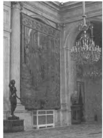
Рис. 7.4.4. Хотя камень не назовешь хорошим проводником тепла, он все же далеко не такой мощный теплоизолятор, как стекловолокно с содержащимся в нем воздухом. В средневековых замках зимой было чрезвычайно холодно, потому что тепло слишком легко утекало через их каменные стены. Этот гобелен замедляет выход тепловой энергии наружу и помогает удерживать в зале тепло.
