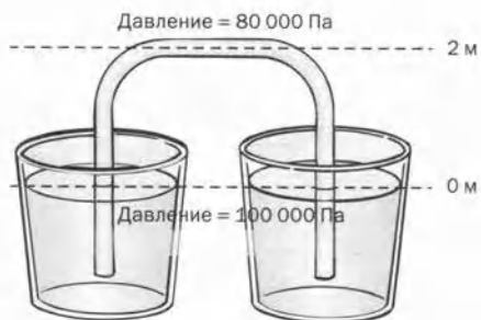
Рис. 5.2.7. Два открытых сосуда с водой соединены сифоном. Вода течет через U-образную трубку, пока ее уровень в обоих сосудах не становится одинаковым. Благодаря жесткости трубки давление воды в сифоне может опускаться ниже атмосферного.
