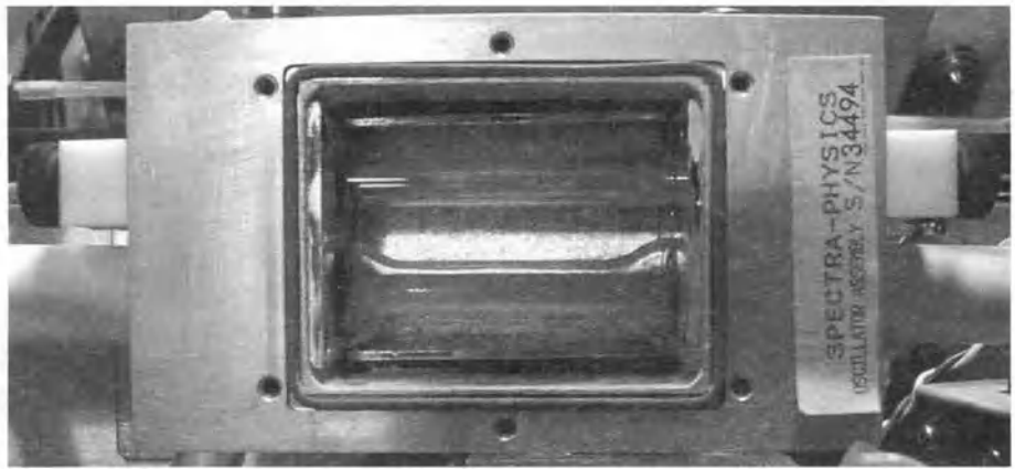
Рис. 14.3.5. Лазерный усилитель с ламповой накачкой содержит фиолетовый алюмо-иттриевый, легированный неодимом (Nd:YAG) стержень. Защищенный стеклянной трубкой стержень расположен в нижней части открытого блока усилителя, стенки которого покрыты золотом. Свет от длинной импульсной лампы в верхней части коробки переводит ионы неодима в возбужденное состояние, в результате чего они могут усиливать инфракрасный свет, горизонтально проходящий через стержень.
