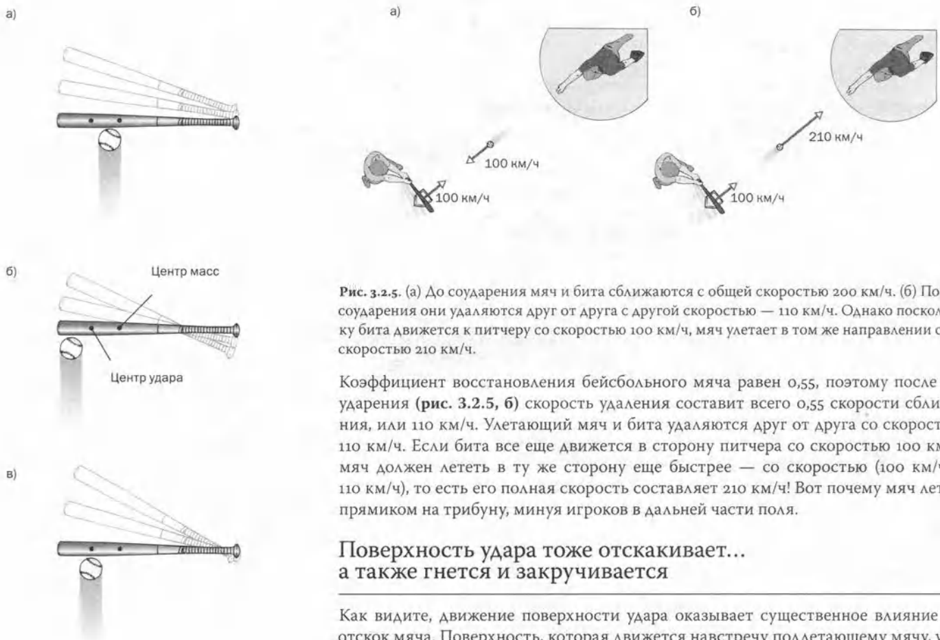
Рис. 3.2.6. При соударении с мячом битка приобретает линейное и угловое ускорения. (а) Если мяч попадает в битку ближе к ее середине, угловое ускорение незначительно, и рукоятка приобретает линейное ускорение, направленное назад. (б) Если удар приходится на конец биты, ее угловое ускорение велико, и ускорение рукоятки направлено вперед. (в) А если мяч попадет в центр удара, угловое ускорение будет как раз таким, чтобы рукоятка вовсе не имела никакого ускорения.
