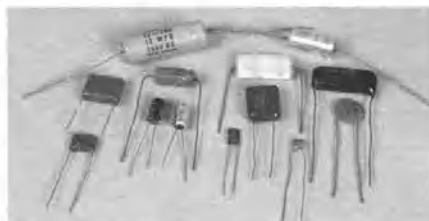
Рис. 12.1.9. Конденсаторы накапливают электрический заряд. Каждый из этих конденсаторов содержит две проводящие пластины (обкладки), разделенные тонким изолирующим слоем.
