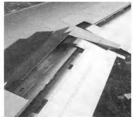
Рис. 6.3.6. Спойлер (аэродинамический тормоз) создает позади крыла турбулентный след. Возникающее в результате сопротивление давления отнимает у самолета энергию, помогая ему терять скорость и снижаться при заходе на посадку.
