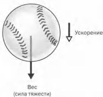
Рис. 1.2.1. Из-за притяжения Земли на мяч действует направленная вниз сила, и эту силу мы называем весом мяча. Именно вес заставляет мяч падать с ускорением, направленным вниз.
